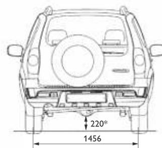
\* 200-240 мм в эксплуатации, 240 мм для автомобиля без пробега в снаряженном состоянии для шин 205/70R15".
